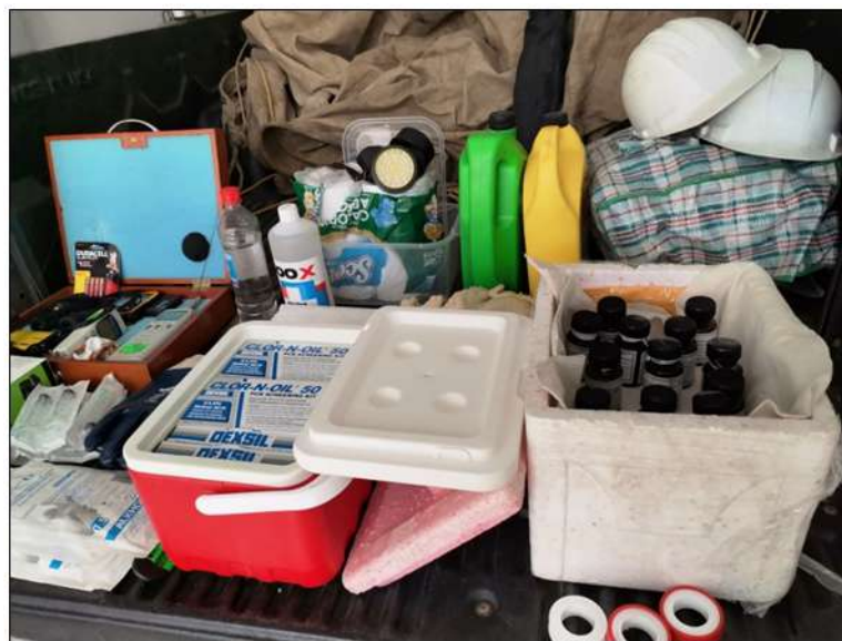
IMAGEN 08: Instrumentos y equipos utilizados en la extracción de aceites y su posterior análisis con los KITS DEXIL
